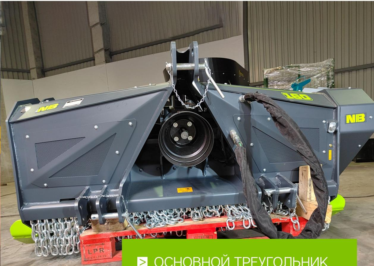
► ОСНОВНОЙ ТРЕУГОЛЬНИК ЦЕНТРАЛЬНОЙ ТЯГИ ИЗ СТАЛИ ТОЛЩИНОЙ 15 ММ
