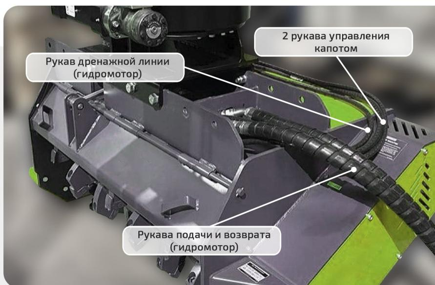
А) При наличии двух гидравлических линий и дренажа, одна из которых двухпоточная (то есть на рукоять носителя выведены 5 рукавов высокого давления) – подключить мульчер с гидравлическим капотом уже можно.
