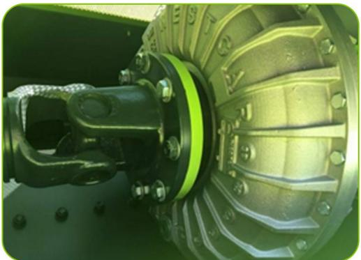
**Гидродинамические муфты (опция).** Реализуют как плавный старт ротора, так и исключение перегрузок во время работы. В отличие от муфт на приводном карданном валу, не останавливает течение энергии к ротору, но при критических нагрузках полностью разрывает вращение.
