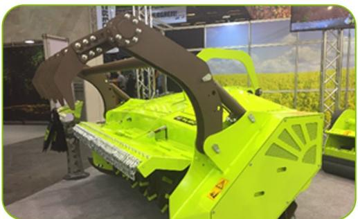
**Толкающая рама** отталкивает предметы от трактора. Она может быть оснащена гидравлическими цилиндрами регулировки наклона (тогда трактор должен иметь еще одну двухпоточную гидравлическую линию).
