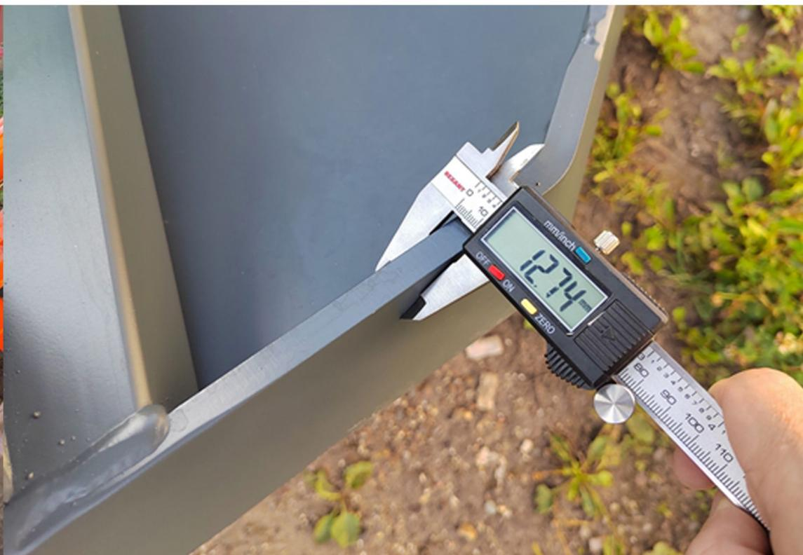
▶ КОРПУС ИЗ СТАЛИ ТОЛЩИНОЙ 12 ММ
