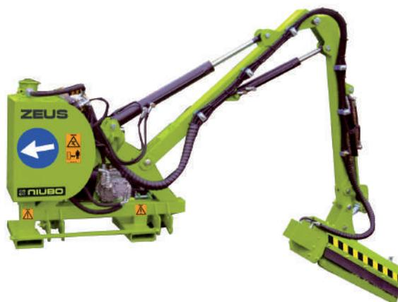
Манипуляторная косилка с собственной гидравлической системой, рекомендуемая мощность трактора 15 - 35 л.с. Служит для содержания канав, откосов дорог и набережных. Рабочая ширина режущей головки от 50 до 80 см
