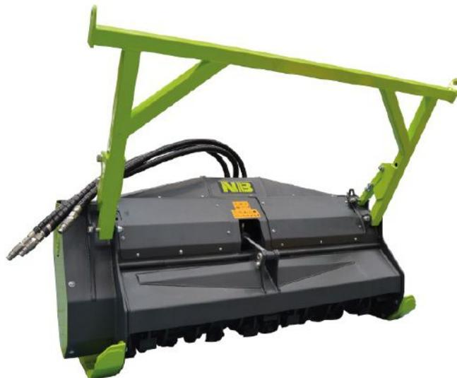
Лесной мульчер с ограничителями реза. Резцы фрезеруют древесину, а за счет их формы – идеально подходят также для измельчения кустарника и мелкой поросли. Резцы самозатачиваемые, с твердосплавной напайкой.
