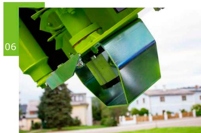
Сменные салазки и защита гидромотора
