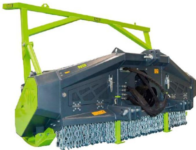
Благодаря двустороннему приводу, ротор диаметром 520 мм предназначен для измельчения древесины диаметром 30 см. Низкий силуэт корпуса обеспечивает оператору хорошую обзорность рабочей площадки. Точки смазки выведены на верх корпуса для удобства обслуживания.
