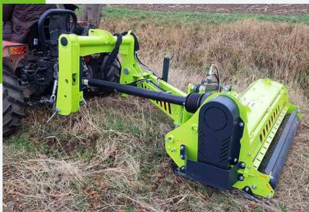
Система смещения с защищенным гидроцилиндром
