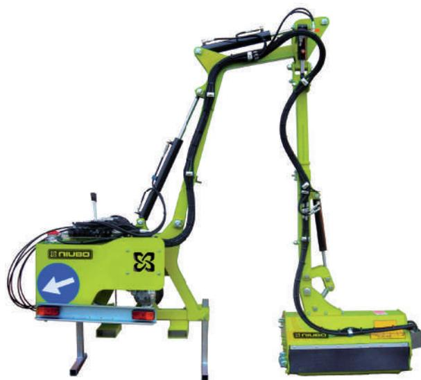
Манипуляторная косилка для носителей рекомендуемой мощностью от 40 до 70 л.с. Служит для содержания канав, откосов дорог и набережных. Рабочая ширина режущей головки от 80 до 100 см
