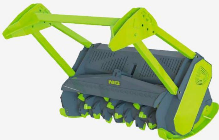
Фиксированные резцы с двумя вставками карбида вольфрама обеспечивают превосходную чистоту среза средних и крупных стволов. Оригинальная конструкция резца для защиты держателя и высокой проникающей способности.
